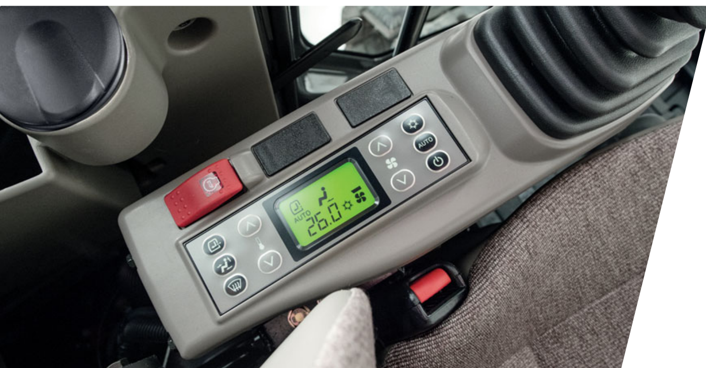
Climatizzatore automatico: eccellente controllo della climatizzazione cabina
